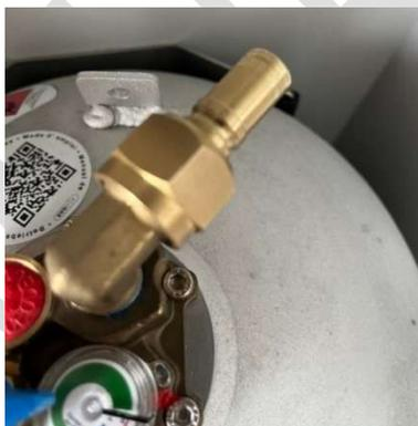
Bild 2 Ventil mit montierter Kupplung und Betätigungsschutz mit Durchzieh-Plombe
